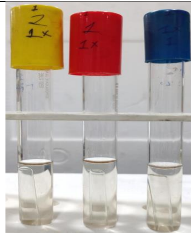
ફિગ.2: ઇમેજ રંગ બદલાવ દર્શાવે છે પરંતુ 1ml (1x) પાણીના નમૂનામાં ગેસનું ઉત્પાદન થયું નથી તેથી, અનુમાનિત પરીક્ષણ નકારાત્મક છે.
